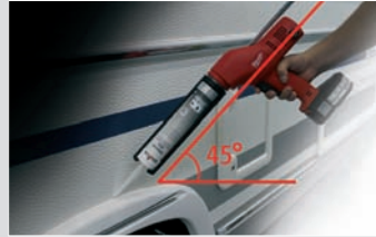
Tragen Sie das Mittel im richtigen Winkel von ca. 45° auf
